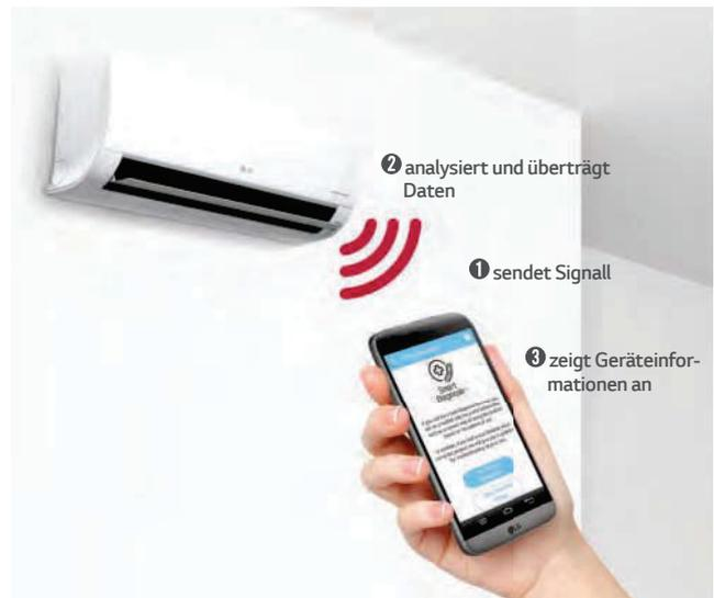
\* Wenn das Modell nicht WLAN-fähig ist kann es mittels der Tonausgabe und Fernsteuerung über die App die Diagnose durchführen.
