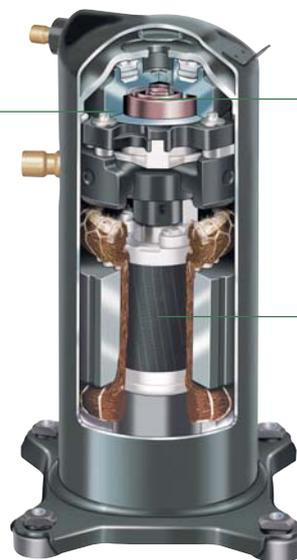
*Bewegliche Spirale, angeschlossen an die Motorwelle, die eine Orbitalbewegung ausführt und Gastaschen erzeugt.*
