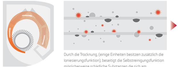
Durch die Trocknung, (einige Einheiten besitzen zusätzlich die Ionisierungsfunktion), beseitigt die Selbstreinigungsfunktion möglicherweise schädliche Substanzen die sich am Wärmetauscher absetzen können.
